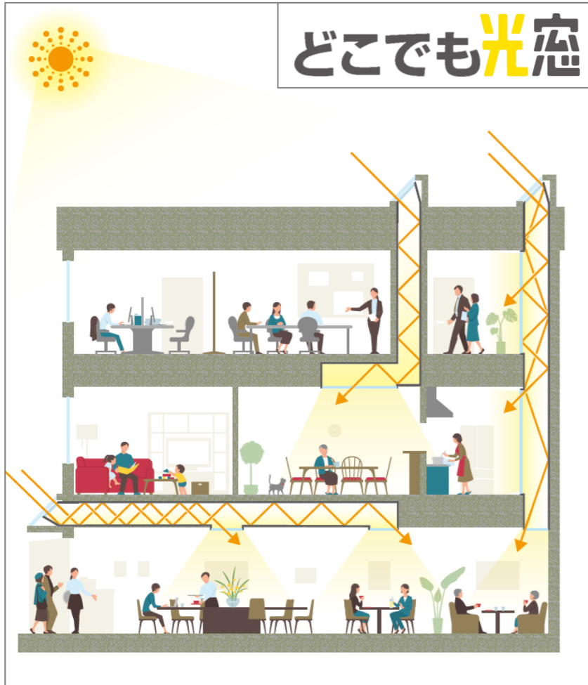
図. 「どこでも光窓」断面模式図
